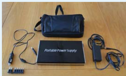
Medili MD-CP12266 Battery Pack (uit de draagtas gehaald), linksvoor het aansluitsnoer voor de cpap (met stekkers voor verschillende apparaten) en rechtsvoor het aansluitsnoer voor het opladen van de Battery Pack.
